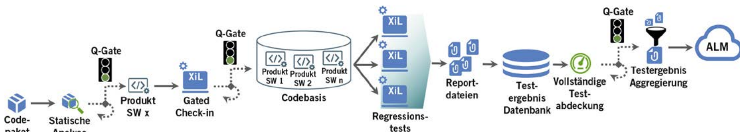
BILD 4 Qualitätsprüfpunkte im Softwaretestprozess (© Valeo)
